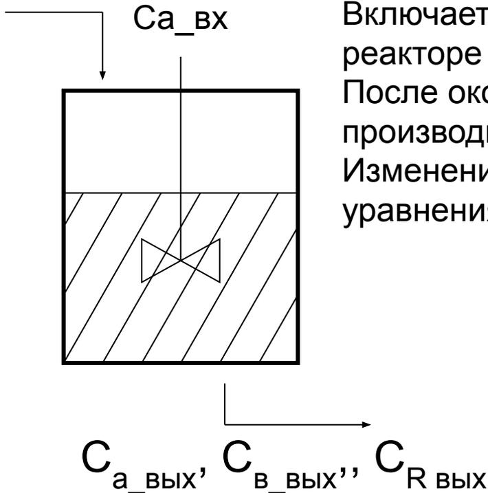
В течение рабочего цикла в реакторе происходит образование полезного (В) и побочного (R) продуктов.
