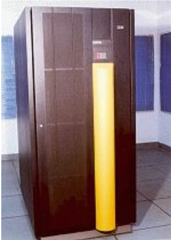
Мэйнфрейм IBM S/390 – продолжение линии S/360-370
