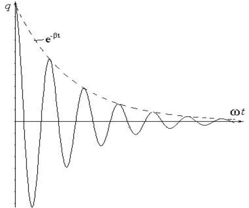
ность колебательного контура -  $Q$ , которая выражает отношение энергии, имеющейся в контуре -  $W$ , к энергии, теряемой им за один период -  $\Delta W$ .
