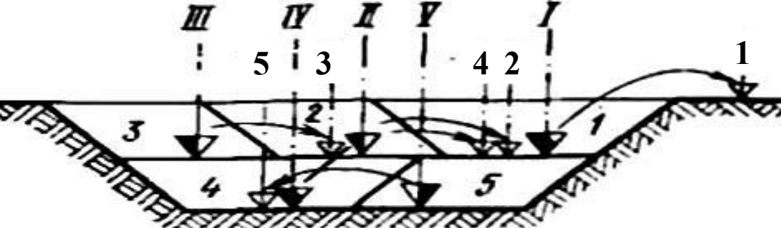
Рис.4. Схема разработки котлована большой глубины последовательными проходками (I–V) экскаватора с прямой лопатой:
