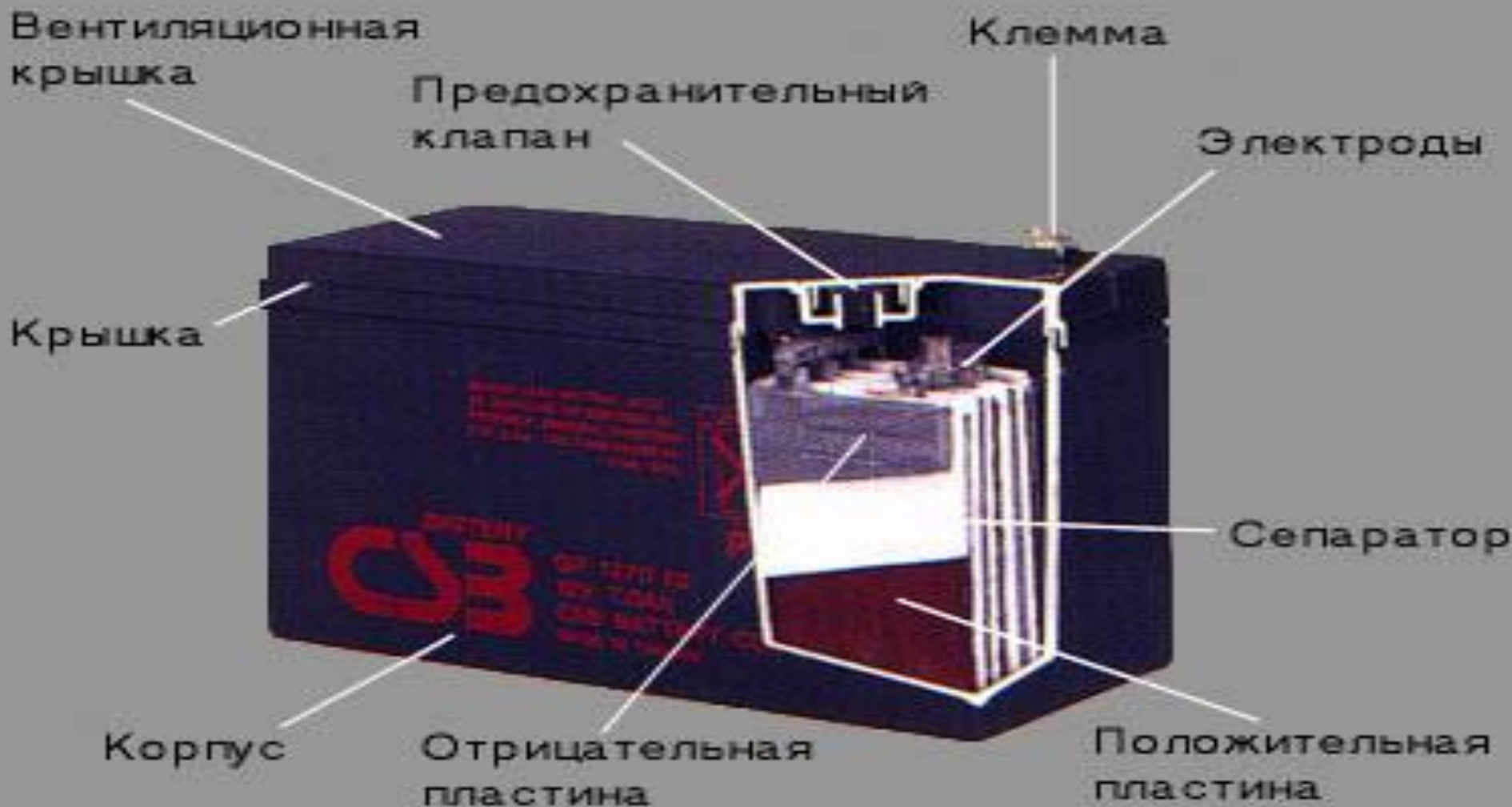
Конструкция батареи серии G P
