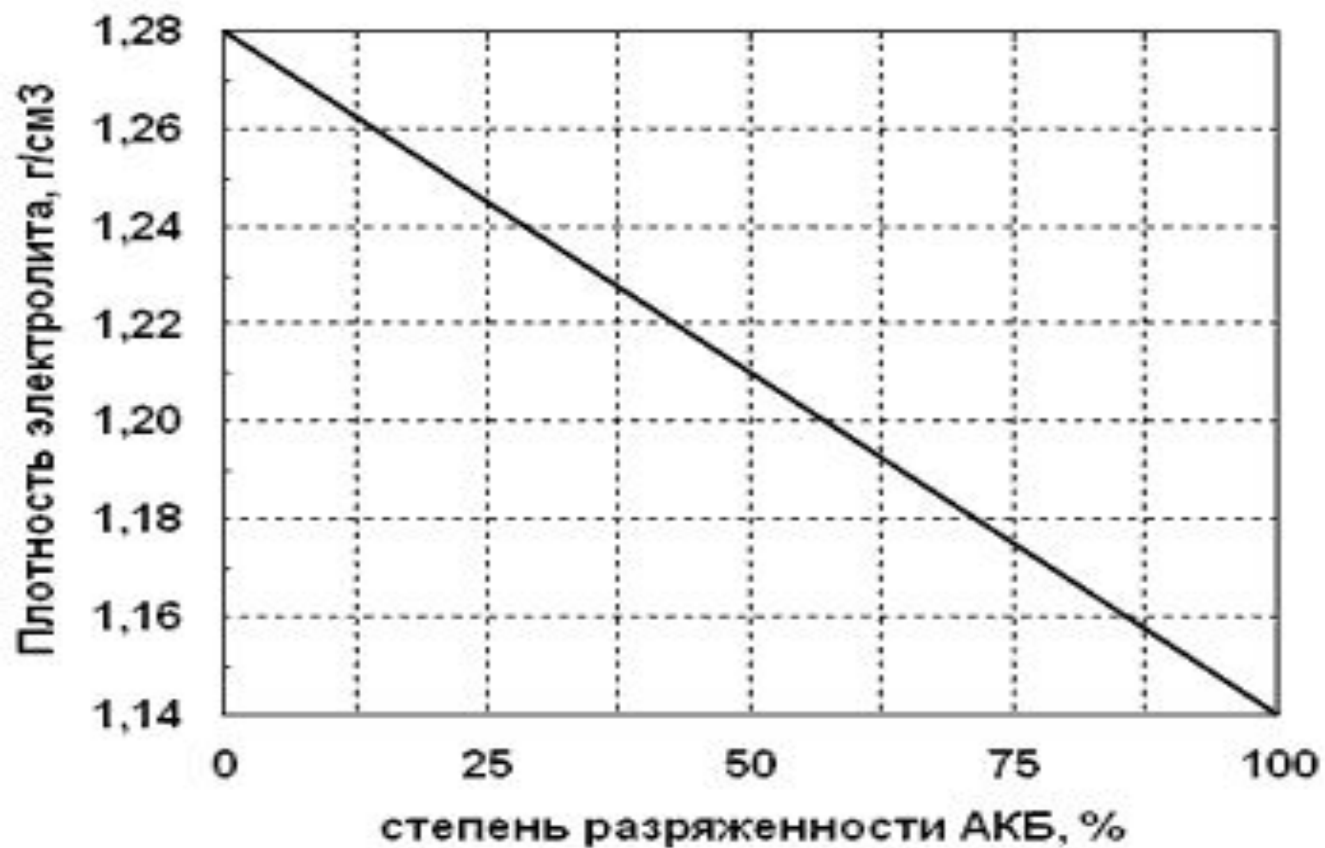
Рис. 4. Зависимость разряженности АКБ от плотности электролита
