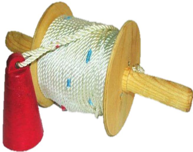
Во времена парусного флота использовалась гиря, обычно свинцовая, с тонкой верёвкой (лотлинем) для измерения глубины. Иногда на нижней части гири формировалось углубление, в которое вкладывалось сало или смесь сала и толчёного мела, чтобы к нему прилипали частицы грунта для определения характера дна.
