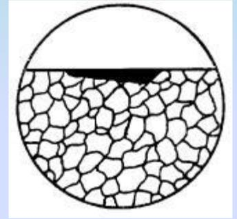
г) Коррозионная язва - коррозионное поражение глубиной приблизительно равной ширине
