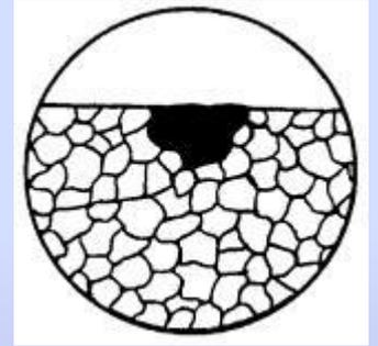
д) Питтинговая коррозия - коррозионное поражение глубиной значительно больше ширины
