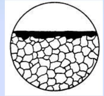
б) Местная (неравномерная) - По форме соответствует сплошной коррозии, но отличается тем, что коррозии подвержена часть поверхности или коррозия протекает с разной скоростью на его отдельных участках
