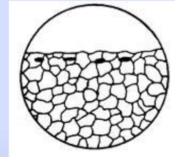
ж) Слойная коррозия - Коррозионное поражение, внутренние слои которого включают зерна различного размера, различные фазы, включения, выделения и др.
