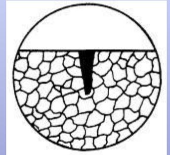
е) Подповерхностная коррозия - коррозионное поражение, характерное тем, что занимает на поверхности небольшую площадь и преимущественно сосредоточена под поверхностью металла
