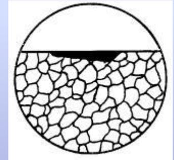
в) Коррозия пятнами - мелкое коррозионное поражение неправильной формы; размер его площади в случае небольшого увеличения может превышать размер поля зрения
