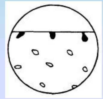
к) Избирательная коррозия - коррозионное поражение, которому подвергнута определенная структурная фаза или компонент; если фаза образована эвтектикой, определяют, прокорродирована вся эвтектика или некоторая ее составляющая, например, цементит
