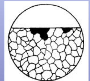
л) Коррозия в виде редких трещин -
