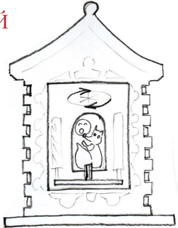
В конструкции используется зубчатая передача, вращаемая приводной ручкой, и мальтийский механизм, который перемещает фигурки с персонажами сказки – именно он заставляет их останавливаться напротив окна.
