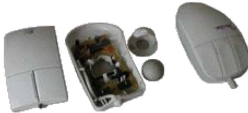
Одной из важных характеристик мыши является ее разрешение, которое измеряется в dpi. Разрешение определяет минимальное перемещение, которое способен почувствовать контроллер мыши. Чем больше разрешение, тем точнее позиционируется мышь, тем с более мелкими объектами можно работать. Нормальное разрешение мыши лежит в диапазоне от 300 до 900 dpi.
