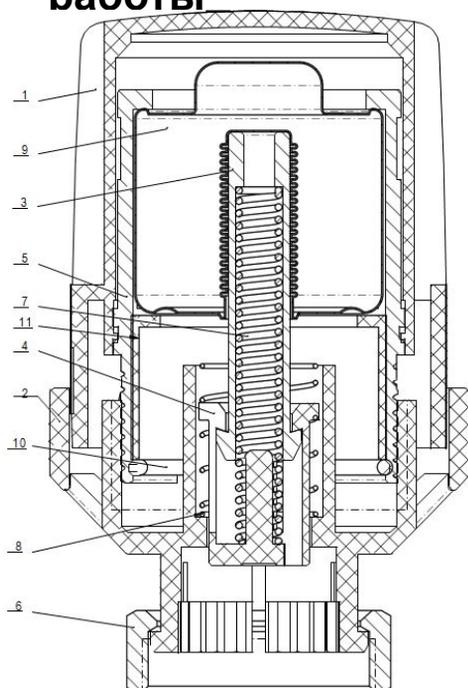
Сильфонная емкость 9, помещенная в пластиковый неподвижный полукорпус 1, заполнена метанолом (толуолом). Расширение жидкости приводит к воздействию сильфона на пластиковый шток 3 с толкателем 4, подпружиненным пружинами 7 и 8. Толкатель 4 воздействует на шток термостатического клапана.
