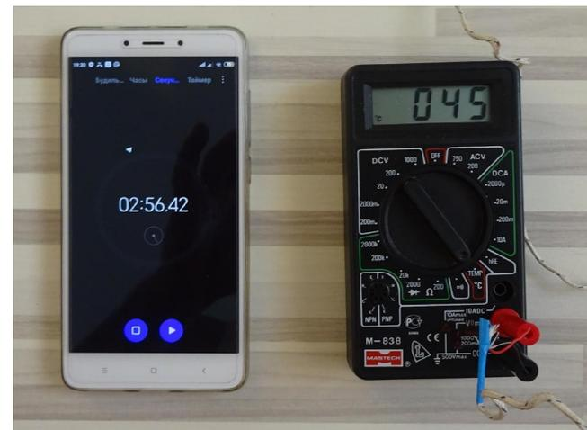
Контролировали процесс и время нагрева пластины от комнатной температуры  $30^{\circ}\text{C}$  до температуры  $45^{\circ}\text{C}$ . Время нагрева оказалось равным 88 секундам.
