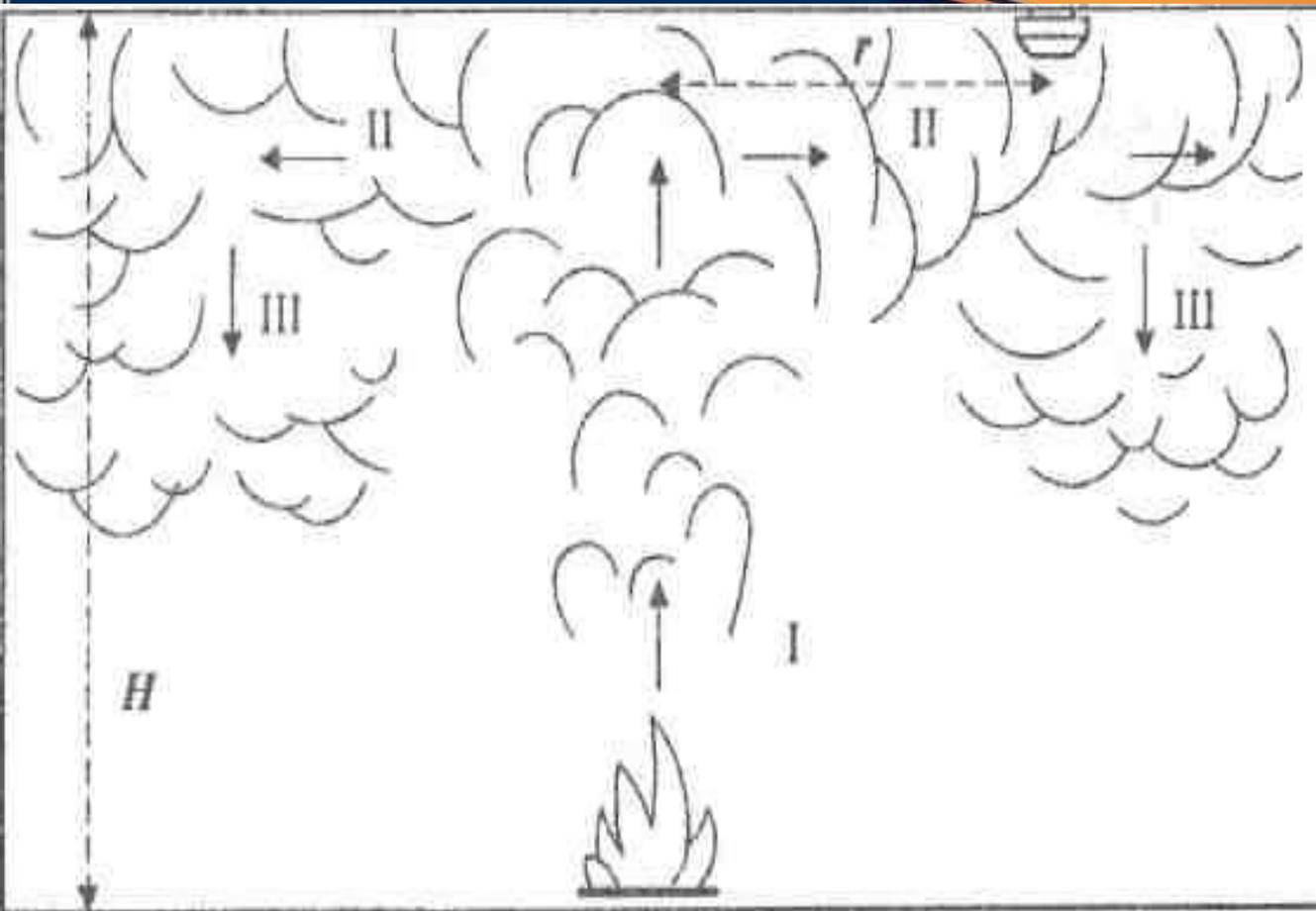
Сначала поток теплого воздуха и образующегося дыма под действием архимедовой силы поднимается вверх (I). Затем он растекается в радиальных направлениях под потолком (II). После достижения стен помещения, происходит накопление газодымовоздушной смеси в подпотолочном пространстве (III)
