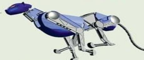
**Гибкий позвоночник** робота-гепарда компании Boston Dynamics позволяет ему развивать скорость бега 30 км/час.
