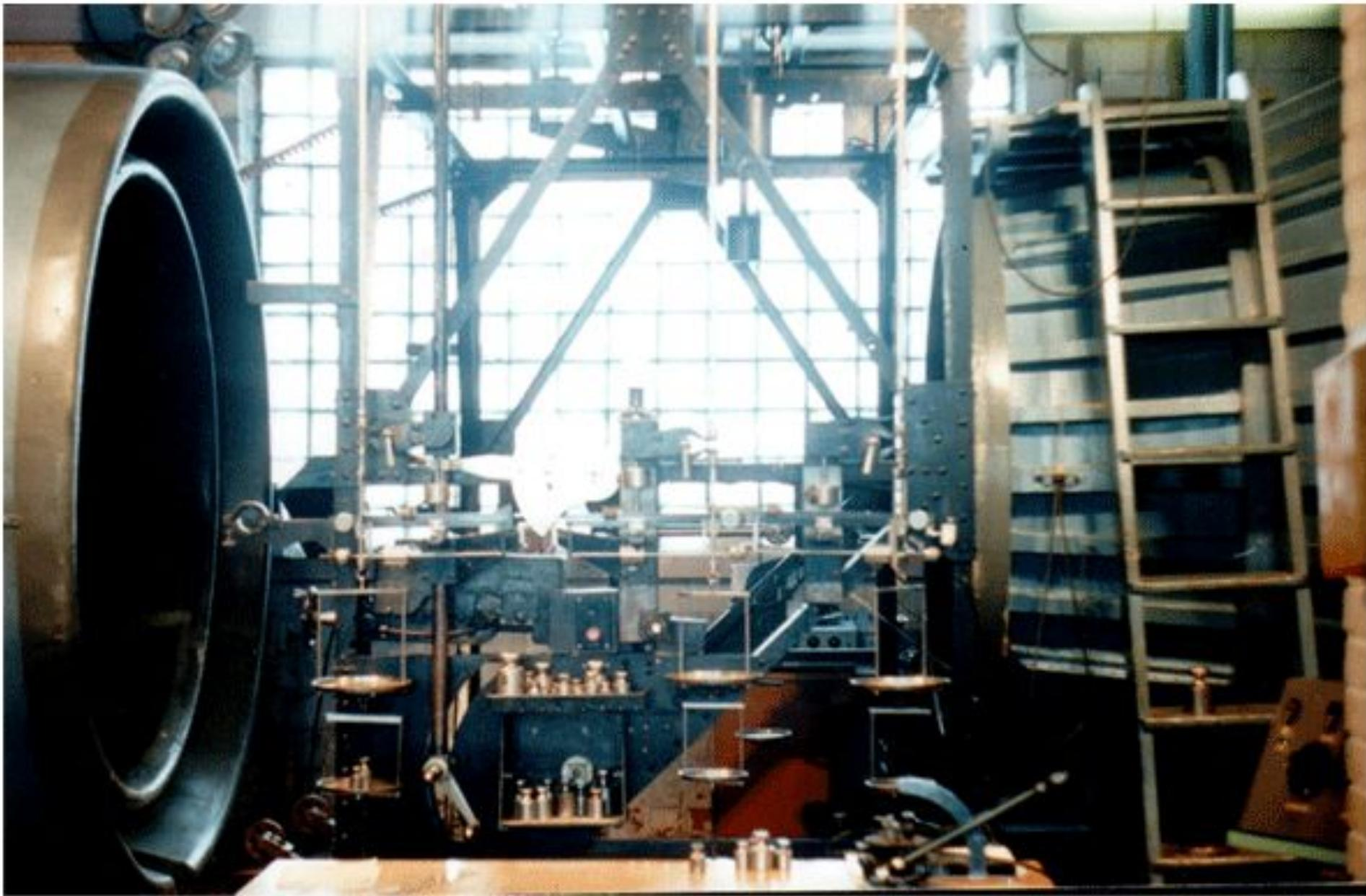
Аэродинамические трубы являются эффективным средством решения как собственно аэродинамических задач судостроения (аэродинамика надстроек и взлетных палуб, ветрозащита ходовых мостиков, задымляемость надстроек, проектирование судовой вентиляции), так и задач гидродинамики судна, не связанных с влиянием волнообразования на свободной поверхности жидкости и с кавитацией. К числу таких задач относятся задачи управляемости надводных судов, а также ходкости и управляемости подводных судов и аппаратов.
