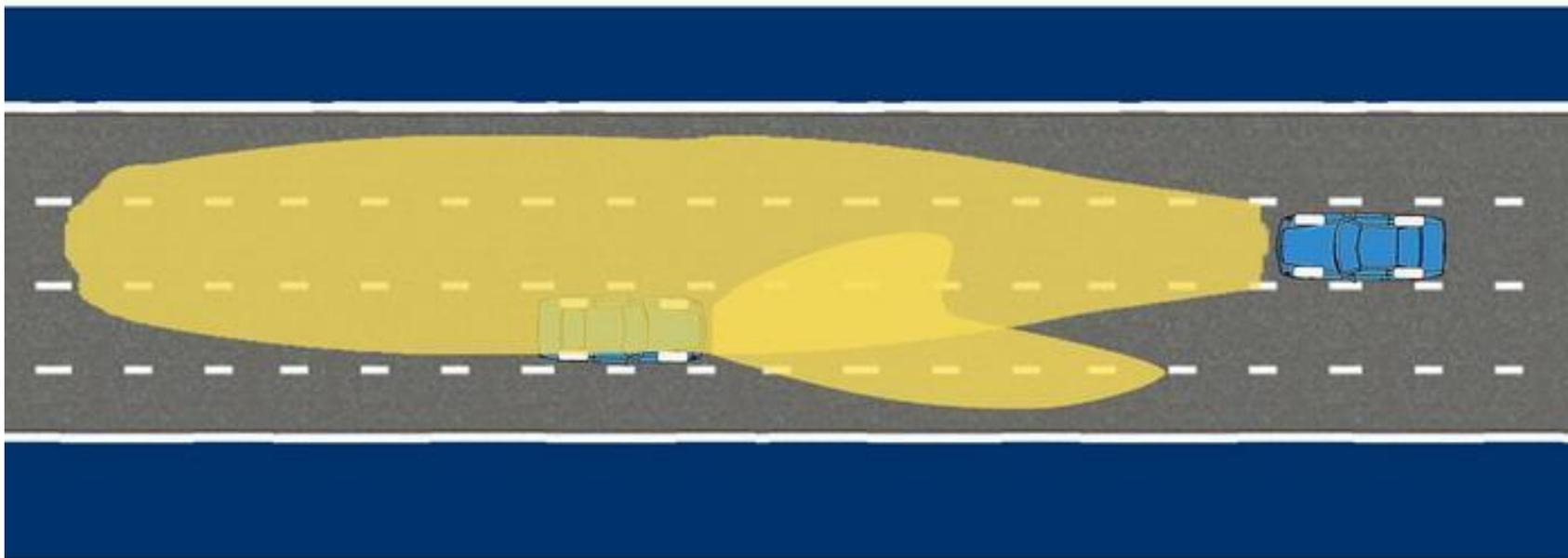
«Ближний» свет фар освещает дорогу на расстояние 50 метров, а «дальний» - примерно на 200-300 метров.
