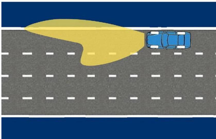
Фары предназначены для того, чтобы освещать дорогу в темное время суток и в условиях недостаточной видимости. Свет фар подразделяется на "ближний", освещающий дорогу на расстояние 50 метров и "дальний", освещающий примерно на 200-300 метров.
