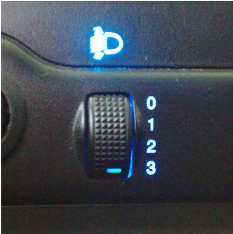
Почти все автомобили оборудованы корректором фар. С его помощью можно регулировать направление пучков света фар - отклонять их вверх или вниз.
