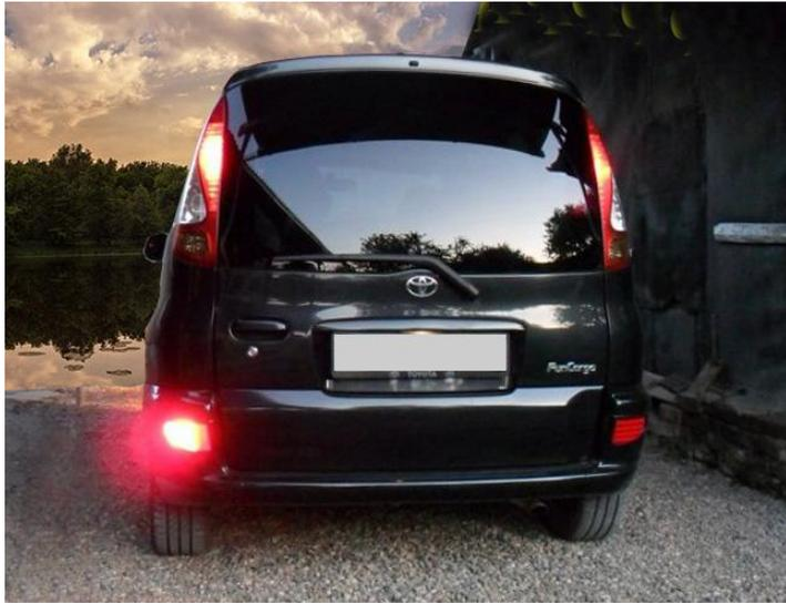
Если противотуманными фарами оборудована только часть автомобилей, то **противотуманные фонари** есть на каждом, если он выпущен позднее 1980 года.
