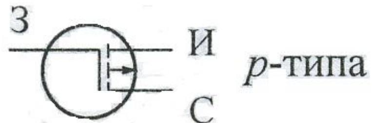
Достоинством полевых транзисторов является отсутствие затрат мощности на управление и высокое быстродействие в результате переноса тока носителями одного знака, что позволяет их использовать на большие Частоты. Недостатком является низкое напряжение и соответственно мощность приборов.
