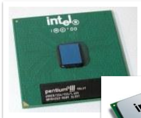
Pentium-III, Celeron 2000 - 2001 28 млн. транзисторов частоты до 1 ГГц
