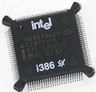
Intel 80386 1985 275 000 транзисторов виртуальная память
