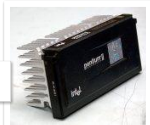
Pentium-II, Celeron 1997 - 2000 7,5 млн. транзисторов частоты до 500 МГц
