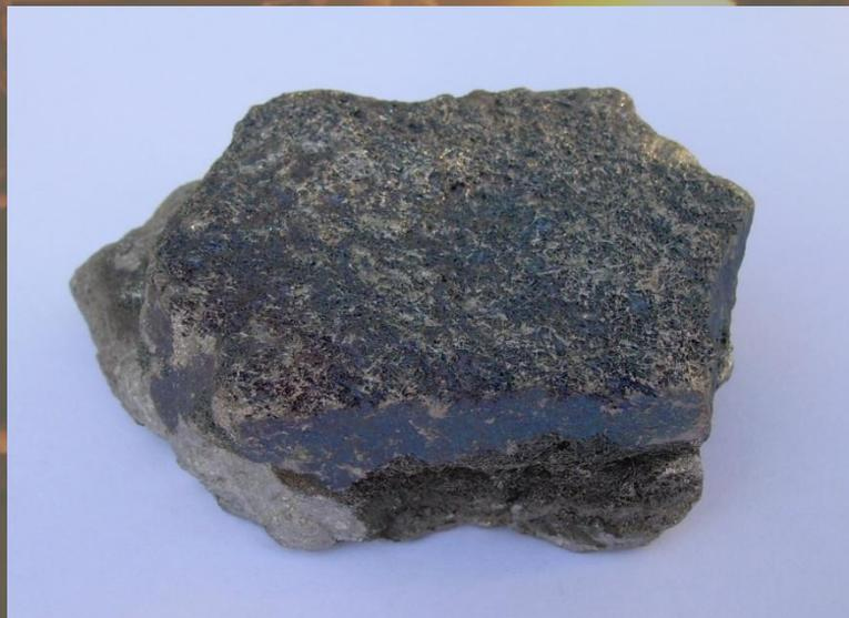
**Феррохром** — сплав железа и хрома (около 60%),
