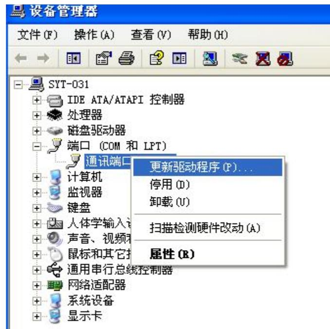
连接USB线后，右击未知端口更新驱动程序
