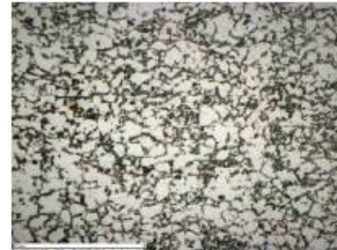
Рис. 5.11. Феррито-мартенситная структура после закалки из межкритического интервала
