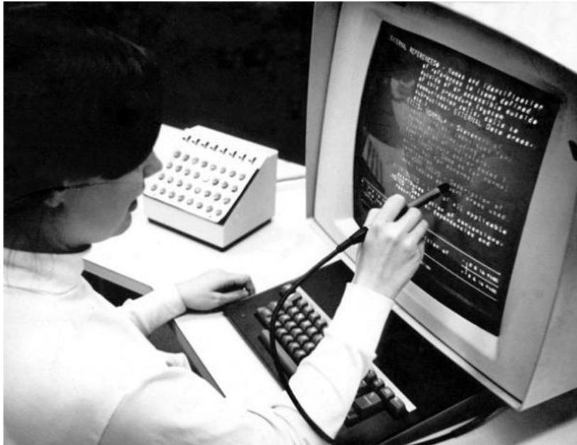
□ Разработано **световое перо**, на кончике которого находится фотоэлемент, испускающий электронные импульсы и одновременно реагирующий на пиковое свечение, соответствующее моменту прохода электронного луча.
