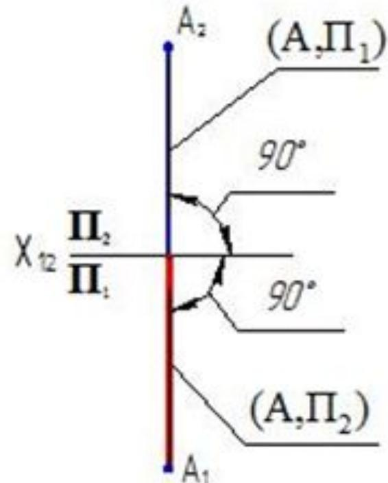
**Ортогональные проекции точки на две взаимно перпендикулярные плоскости однозначно определяют положение точки в пространстве и делают изображения обратимыми.**
