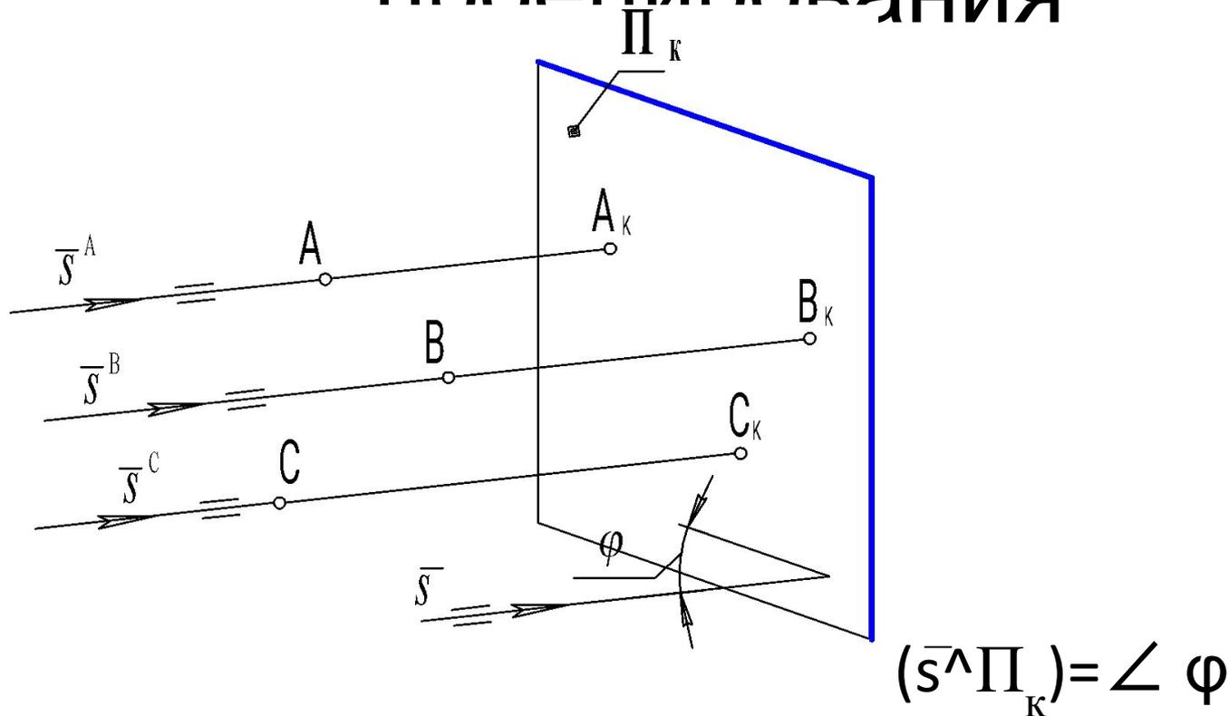
$\angle \varphi = 90^\circ \quad V(\vec{s} \perp \Pi_k) \Rightarrow$  проецирование прямоугольное
