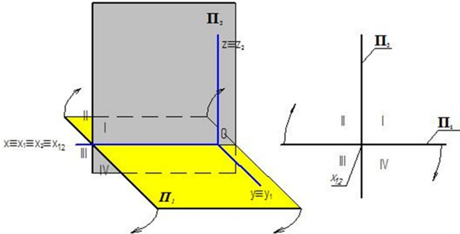
Систему координат  $Oxyz$  совмещают с плоскостями проекций:  $Oxz \equiv \Pi_2$ ,  $Oxy \equiv \Pi_1$ ,  $Ox \equiv (1,2)$
