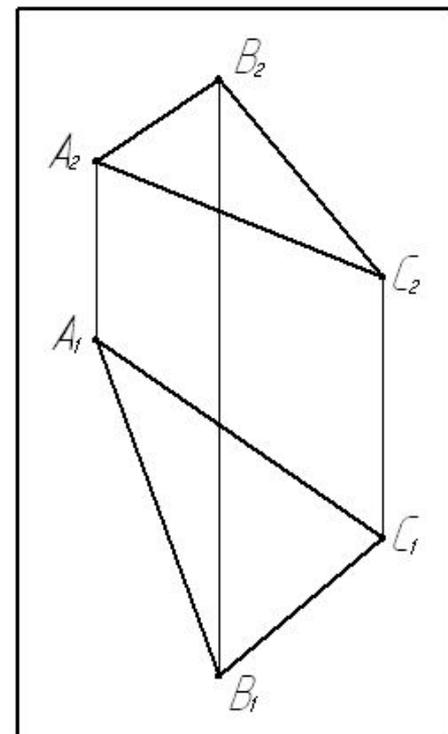
Вывод: Ни одна из проекций плоскости не имеет форму прямой линии
