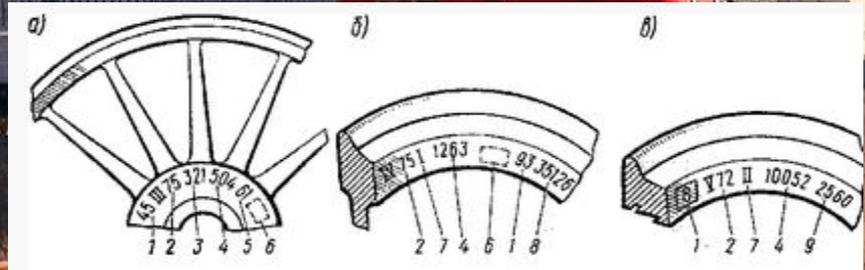
1 — номер завода-изготовителя; 2 — дата изготовления; 3 — номер партии; 4 — номер плавки; 5 — номер колесного центра; 6 — клеймо приемки; 7 — марка; 8 — номер колеса; 9 — номер бандажа
