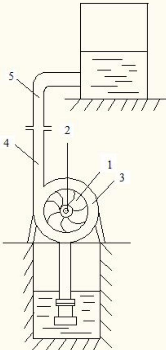
В центробежном одноступенчатом насосе на валу 2 жестко закреплено рабочее колесо 1 с криволинейными лопатками. Вал приводится во вращение от электродвигателя непосредственно через редуктор или клиноременную передачу. Рабочее колесо помещено в корпус 3 насоса, выполненный в виде спиральной камеры переменного сечения с напорным 4 и приемным 5 патрубками.
