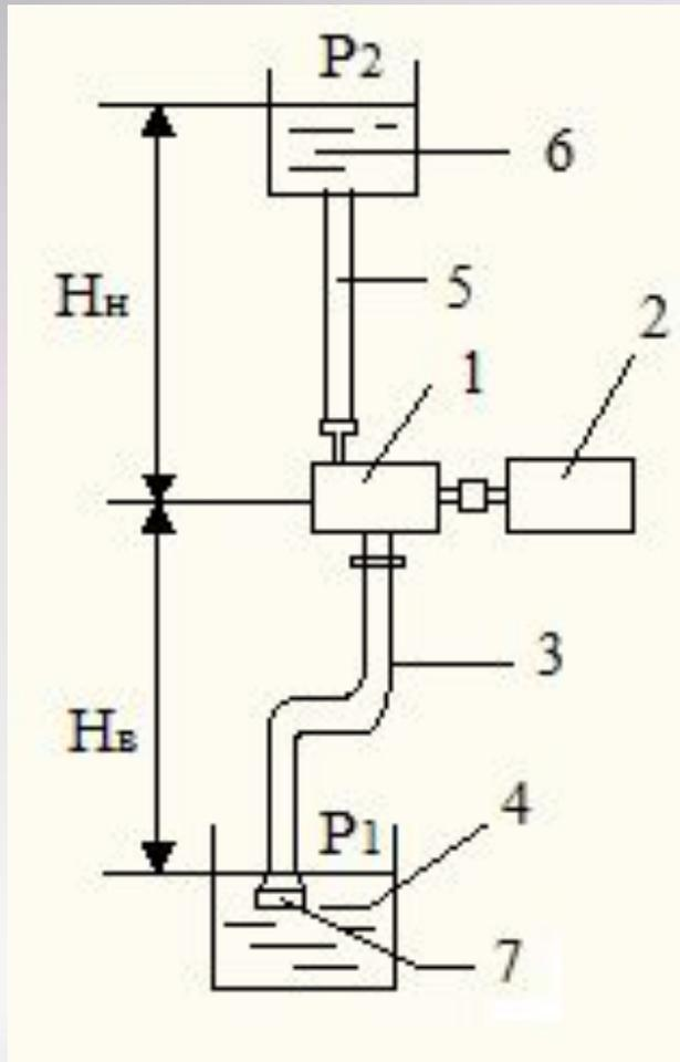
Насосная установка состоит из насоса 1 с приводом 2, всасывающего водопровода 3, соединяющего насос с местом забора жидкости из приемной жидкости 4, напорного трубопровода 5, по которому жидкость подводится к месту назначения, напорного резервуара 6. При перекачке загрязненных жидкостей на конец всасывающего трубопровода надевают сетчатый фильтр 7
