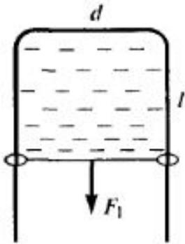
Схема действия сил поверхностного натяжения
