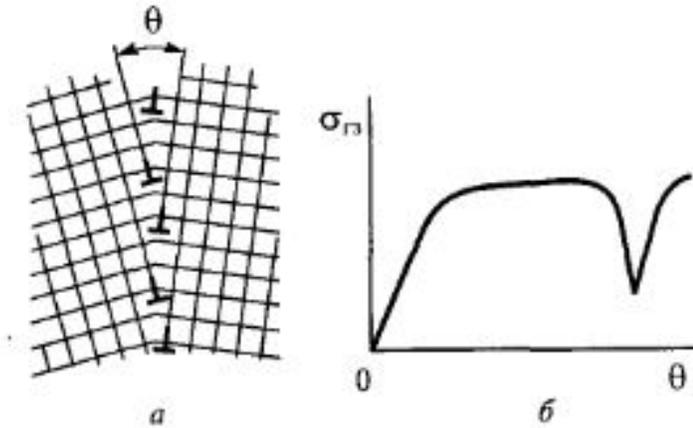
*a)* межзеренная граница при малой разориентации, *б)* зависимость свободной поверхностной энергии от угла разориентации
