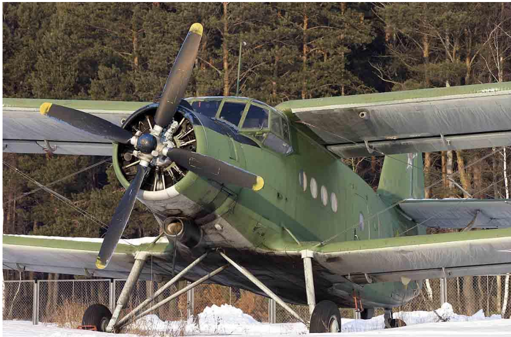
Рис. Ферменное шасси: 1 – амортизационная стойка; 2 – подкос
