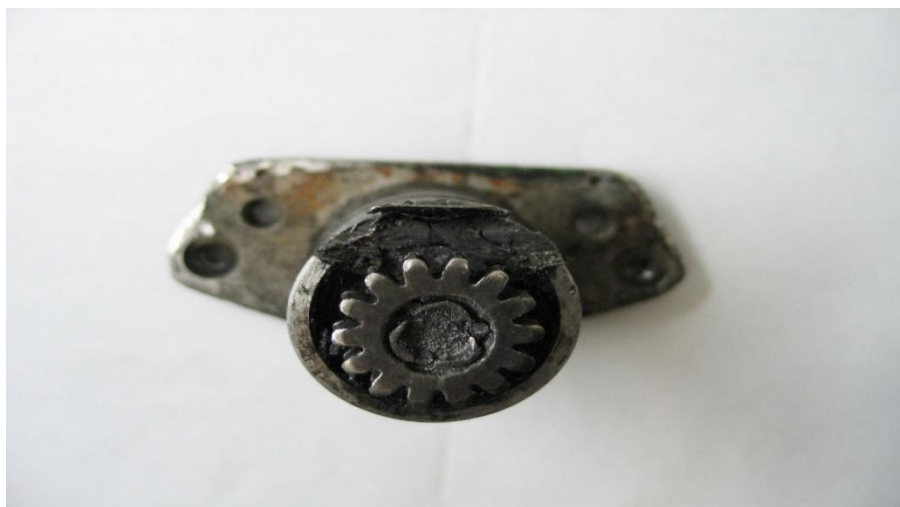
Рис. 18. Разрушение абтюратором привода датчика УА-27
