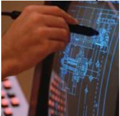
Также световое перо может быть элементом дигитайзера (графического планшета). В этом случае пером пишут или рисуют не по экрану монитора, а по поверхности планшета.
