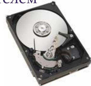
В отличие от «гибкого» диска (дискеты), информация записывается на жёсткие (алюминиевые, керамические или стеклянные) пластины, покрытые слоем ферримагнитного материала, чаще всего двуокиси хрома.
