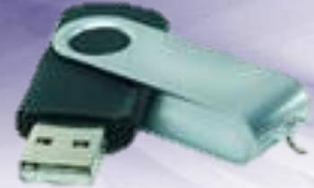
**Flash-память** применяется для долговременного хранения информации и не требует подключения источника электрического напряжения. Такая память не имеет движущихся частей, поэтому обеспечивает высокую сохранность данных при использовании в мобильных устройствах (портативных компьютерах, цифровых камерах и т.д.).
