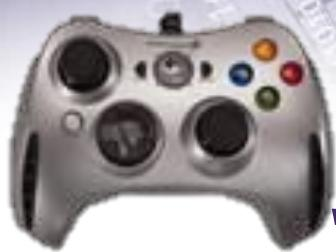
Джойстик – манипулятор, посредством которого можно задавать экранные координаты графического объекта; также может выполнять функции клавиатуры. Джойстики предназначены для более удобного управления ходом компьютерных игр. Обычно они представляют собой рукоятку с кнопками на подставке. Многие звуковые карты имеют специальный игровой порт, к которому подключаются джойстики.
