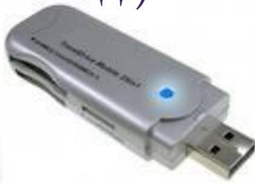
В настоящее время информационная ёмкость **flash-памяти** может достигать 32 Гбайт. **Flash-диск** представляет собой большую интегральную схему памяти, помещенную в миниатюрный корпус. Flash-диск подключается к USB-разъему компьютера.
