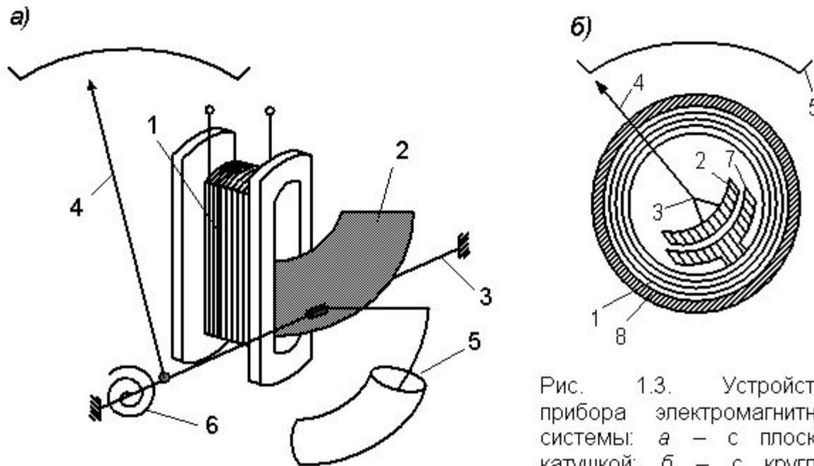
Рис. 1.3. Устройство прибора электромагнитной системы: а – с плоской катушкой; б – с круглой катушкой;
