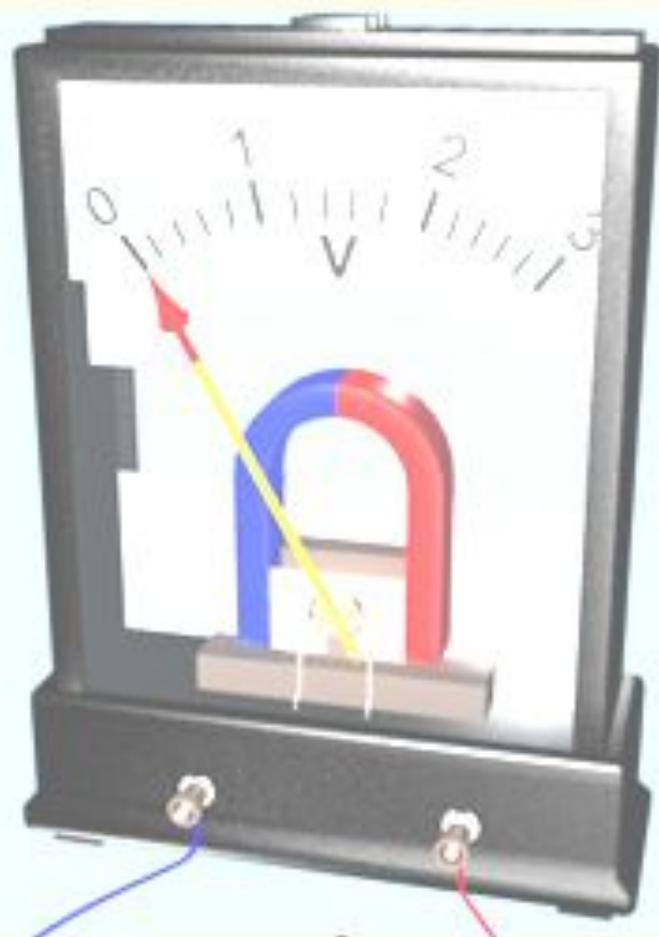
Измерительный механизм магнитоэлектрической системы, снабжён набором шкал и дополнительных сопротивлений.
