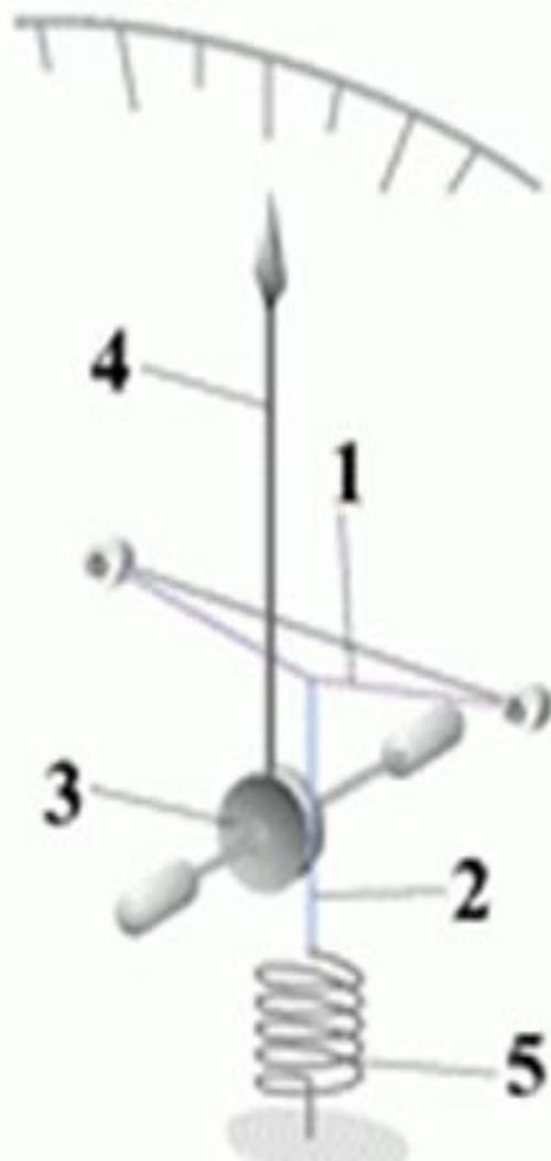
1. Нагревающаяся электрическим током проволока
