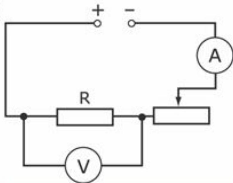
Регулирование напряжения реостатом
