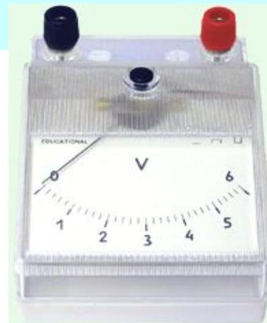
**Электроизмерительные приборы** — класс устройств, применяемых для измерения различных электрических величин. В группу электроизмерительных приборов и другие средства измерений — меры, преобразователи, комплексные установки.
