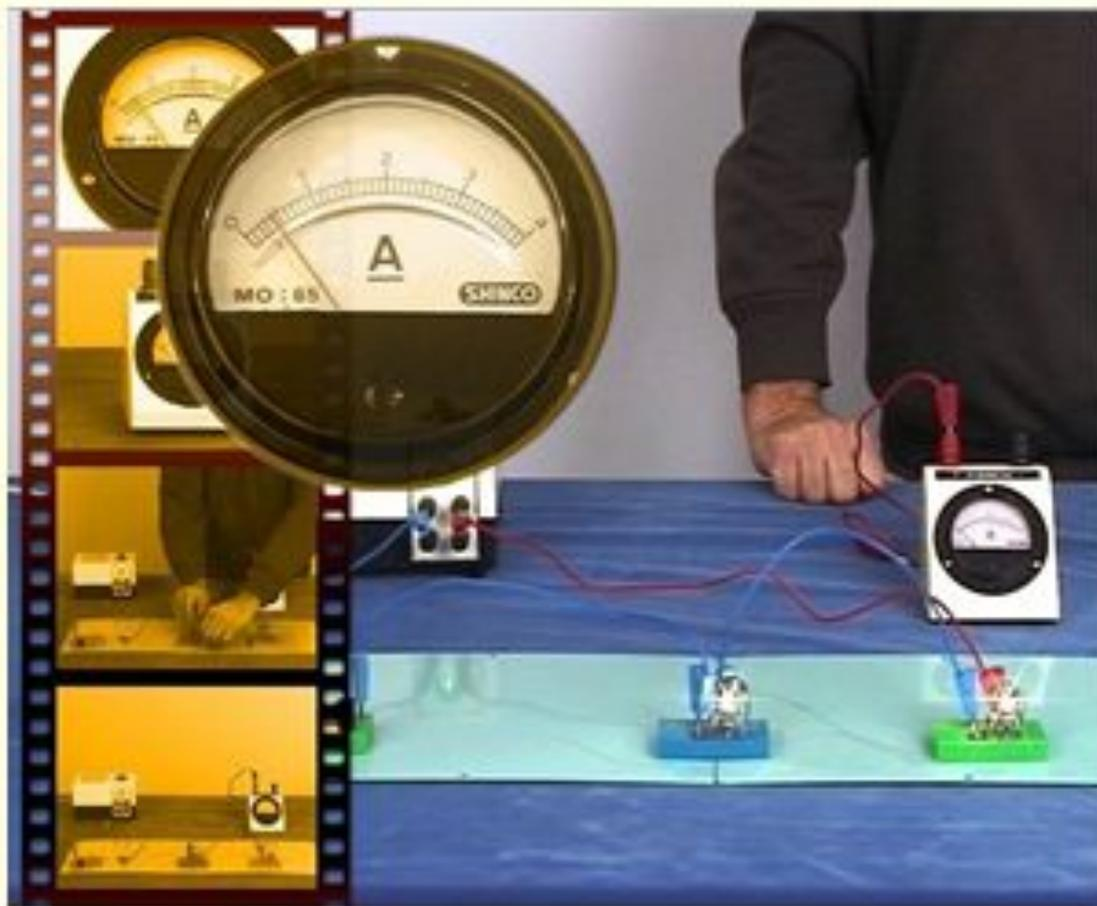
Амперметр включают в электрическую цепь **ПОСЛЕДОВАТЕЛЬНО** с потребителем, соблюдая полярность.
