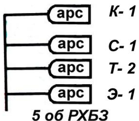
**Район сосредоточения специальных машин**, требующих ремонта (Т, С, К - соответственно текущего, среднего, капитального ремонта, Э - эвакуации; цифры - количество машин), с указанием принадлежности (5 об РХБЗ)
