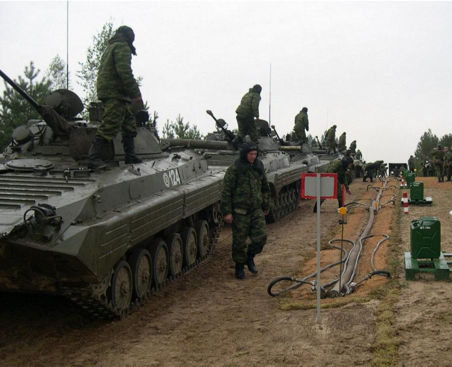
Заправка машин горючим производится штатными средствами заправки и подвоза горючего на пунктах технического обслуживания и зарядки, а также на складе.
