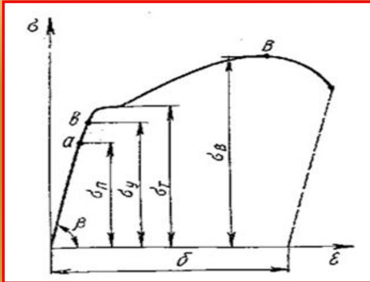
При испытании на растяжение образец растягивается под действием плавно возрастающей нагрузки и доводится до разрушения.
