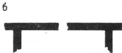
Способы решения разделительных швов а — колонны или стены; б — консоль; в — соединение типа "скользящий шов"
