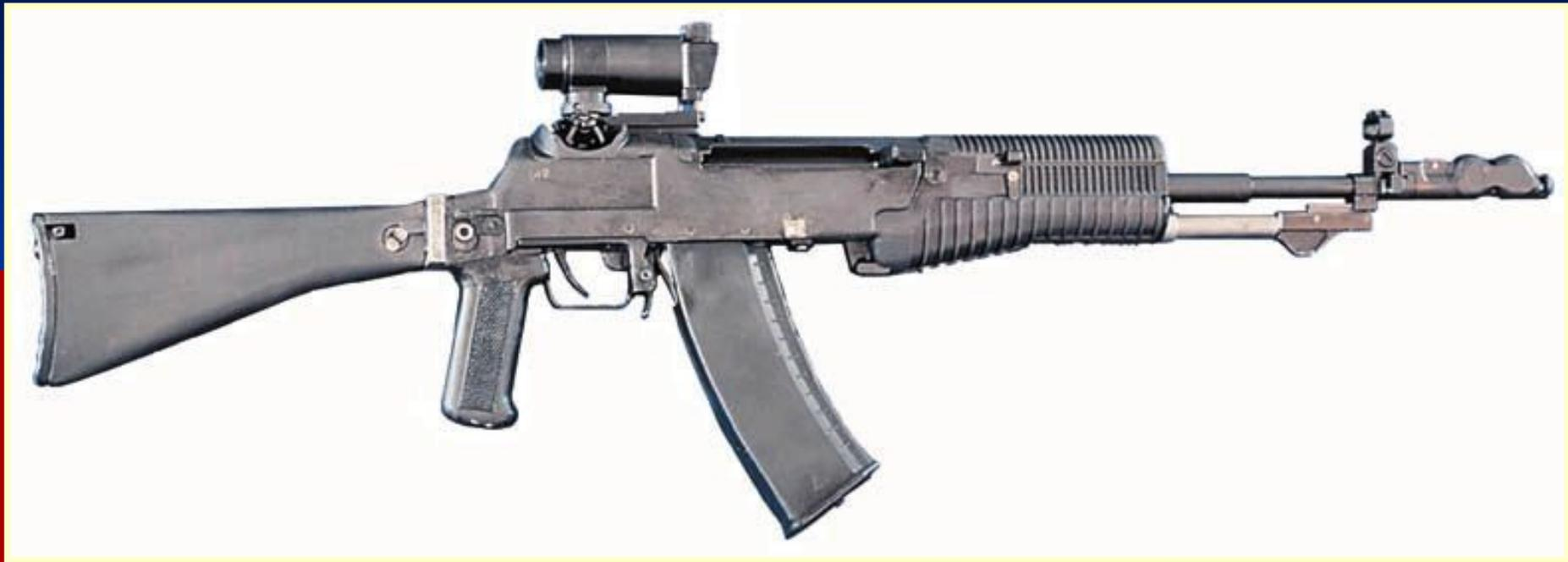
**Использование принципа смещенного импульса отдачи, переменного темпа стрельбы и магазина емкостью 60 патронов позволили повысить эффективность стрельбы в 1,5-2 раза, по сравнению с такими распространенными образцами, как АК-74 и М16А2. При стрельбе очередями первые два выстрела делает в темпе 1800 выстр/мин, затем автоматически переходит на 600 выстр/мин.**
