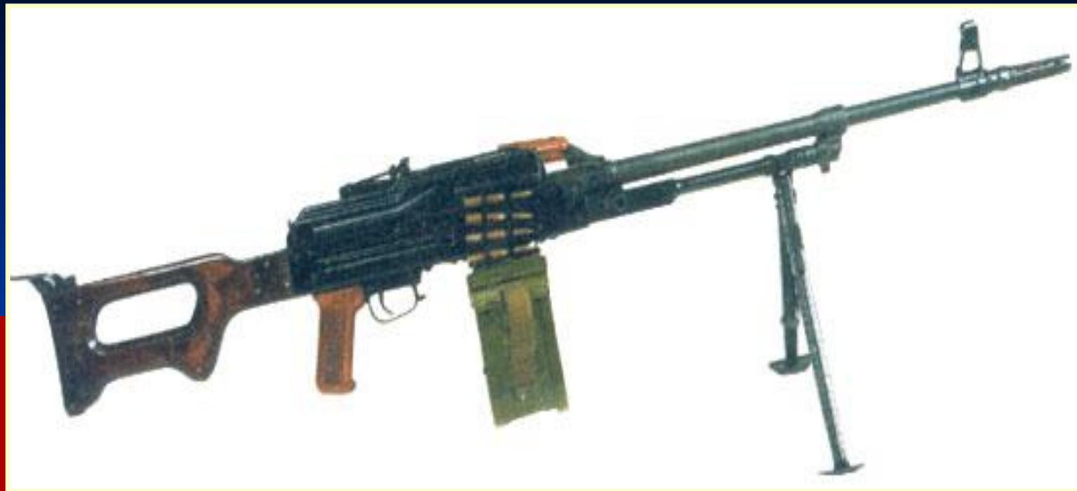
Модернизированный единый пулемет ПКМ, принятый на вооружение в 1969 году, отличается от единого пулемета ПК главным образом изменением технологии изготовления отдельных частей.
