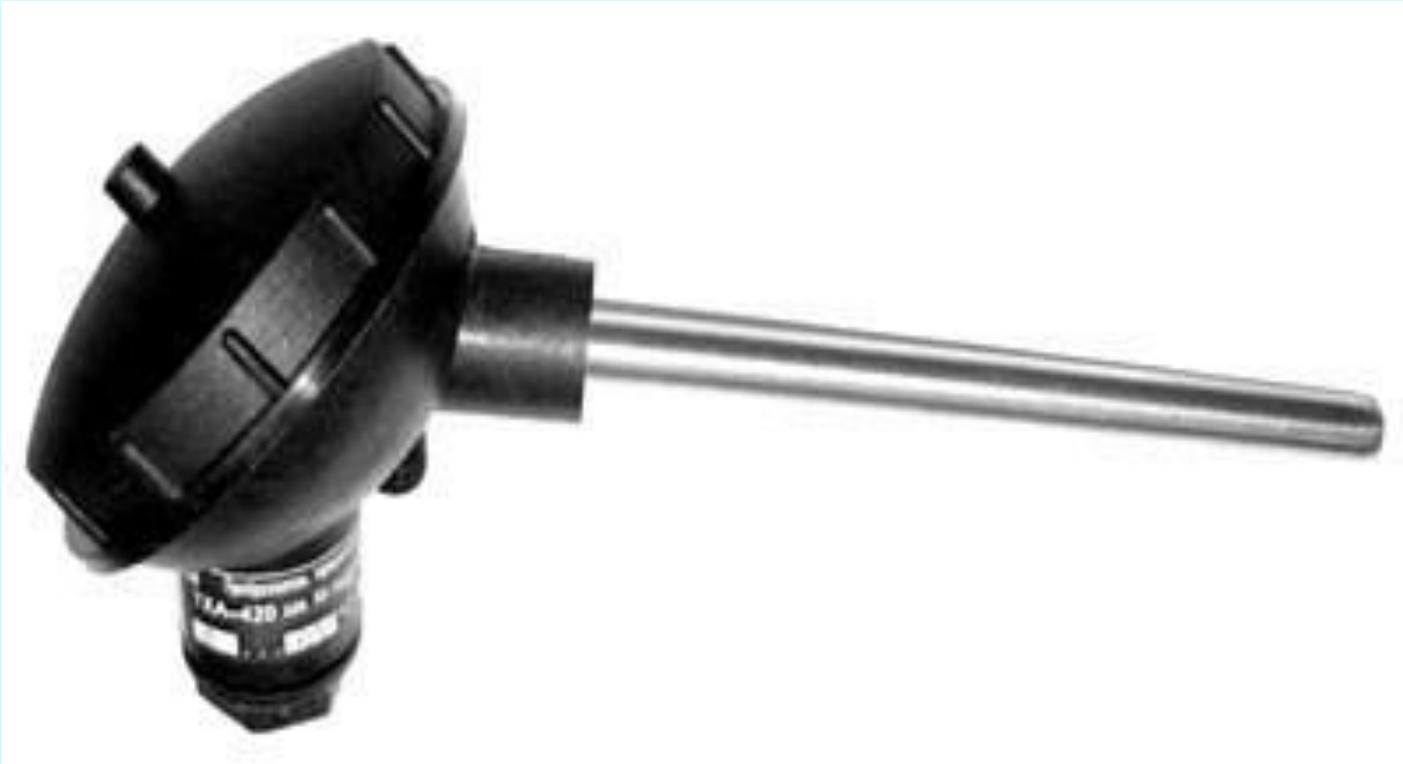
Принцип действия заключается в зависимости сопротивления материалов проводников от температуры.
