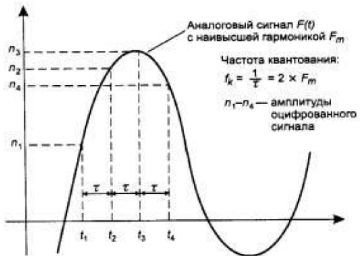
Рис. 8. Дискретная модуляция непрерывного процесса
