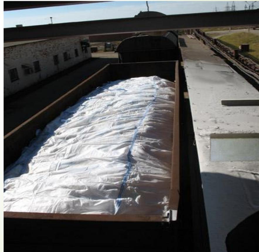
**Течь груза** из вагона объясняется прежде всего его конструкцией и техническим состоянием, а также гранулометрическим составом и влажностью сыпучих грузов и динамическими нагрузками, испытываемыми вагоном в процессе движения поезда.
