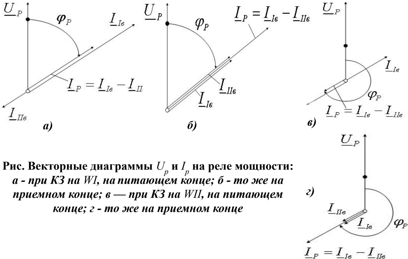
Рис. Векторные диаграммы  $U_p$  и  $I_p$  на реле мощности:
