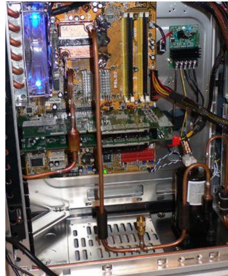
Система охлаждения с помощью фреона
