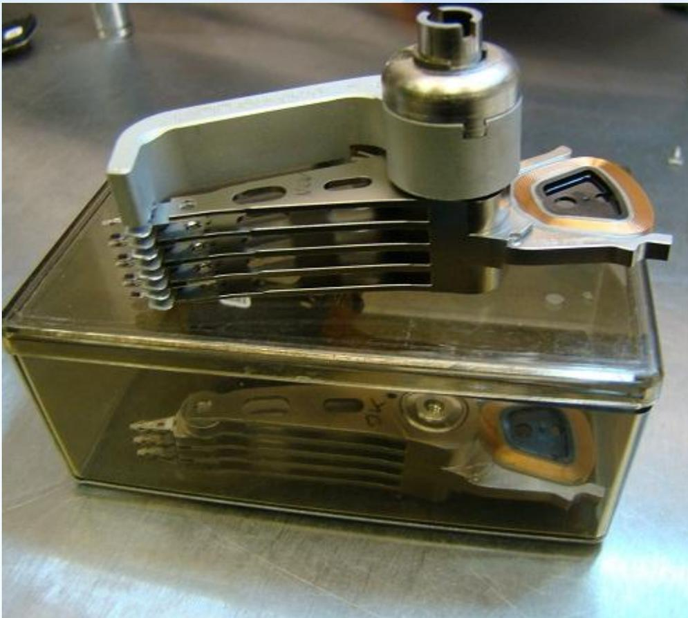
Проявляется поломка головки в ошибках чтения или записи, в процессе работы операционной системы, а также неисправность головки может выявиться при нарушении расположения опоры, на которой она крепится.
