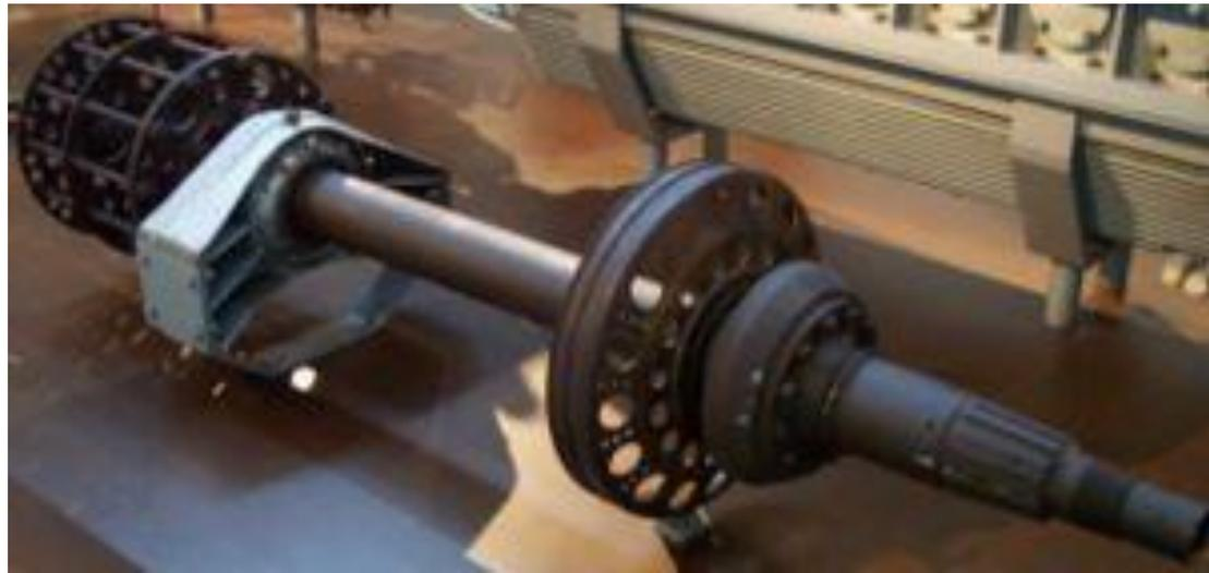
Некоторые валы не поддерживают вращающиеся детали (карданные валы автомобилей, соединительные валки прокатных станков и т. п.), поэтому эти валы работают только на кручение. По назначению различают **валы передач**, на которых устанавливают зубчатые колеса, звездочки, муфты и прочие детали передач, и **коренные валы**, на которых устанавливают не только детали передач, но и другие детали, например маховики, кривошипы и т. д.
