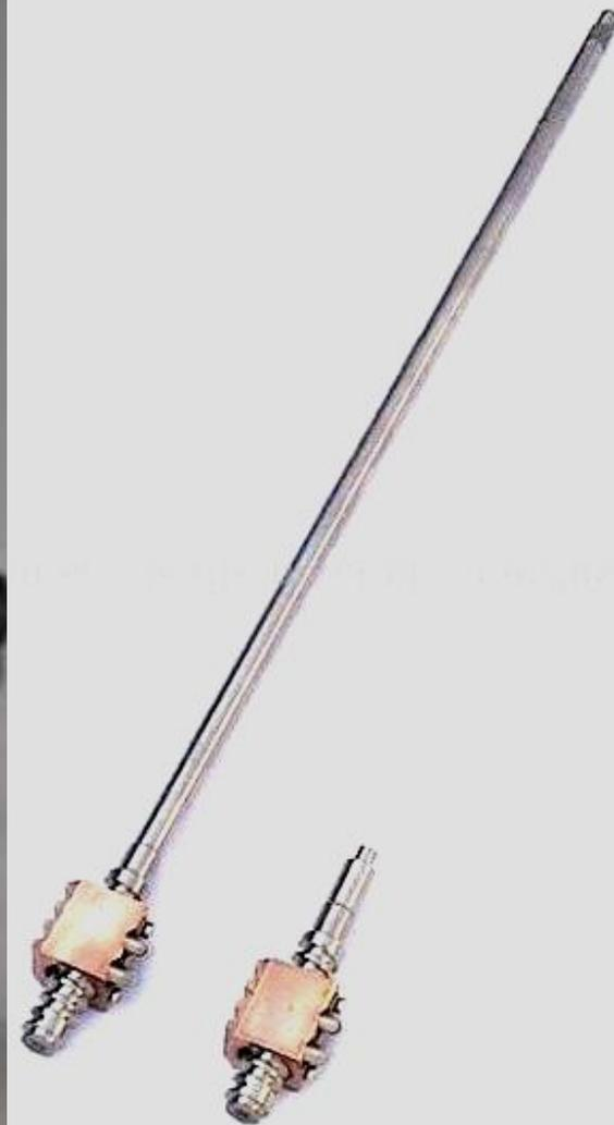
Гибкие валы, представляющие собой многозаходные витые из проволок пружины кручения, применяют для передачи момента между узлами машин, меняющими свое относительное положение в работе (механизированный инструмент, приборы дистанционного управления и контроля, зубоорачебные бормашины и т. п.).
