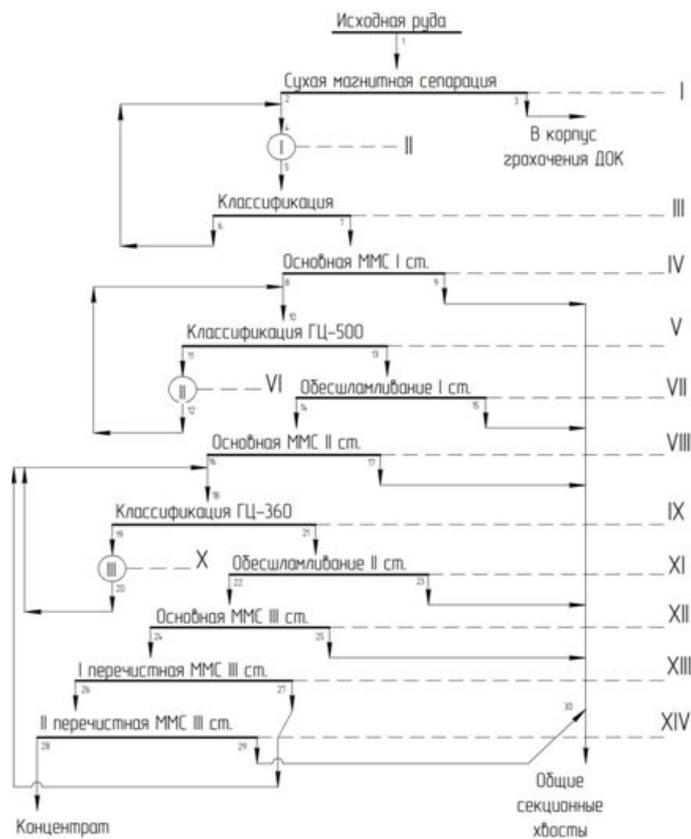
Рисунок 2.1 – Технологическая схема проектируемого корпуса
