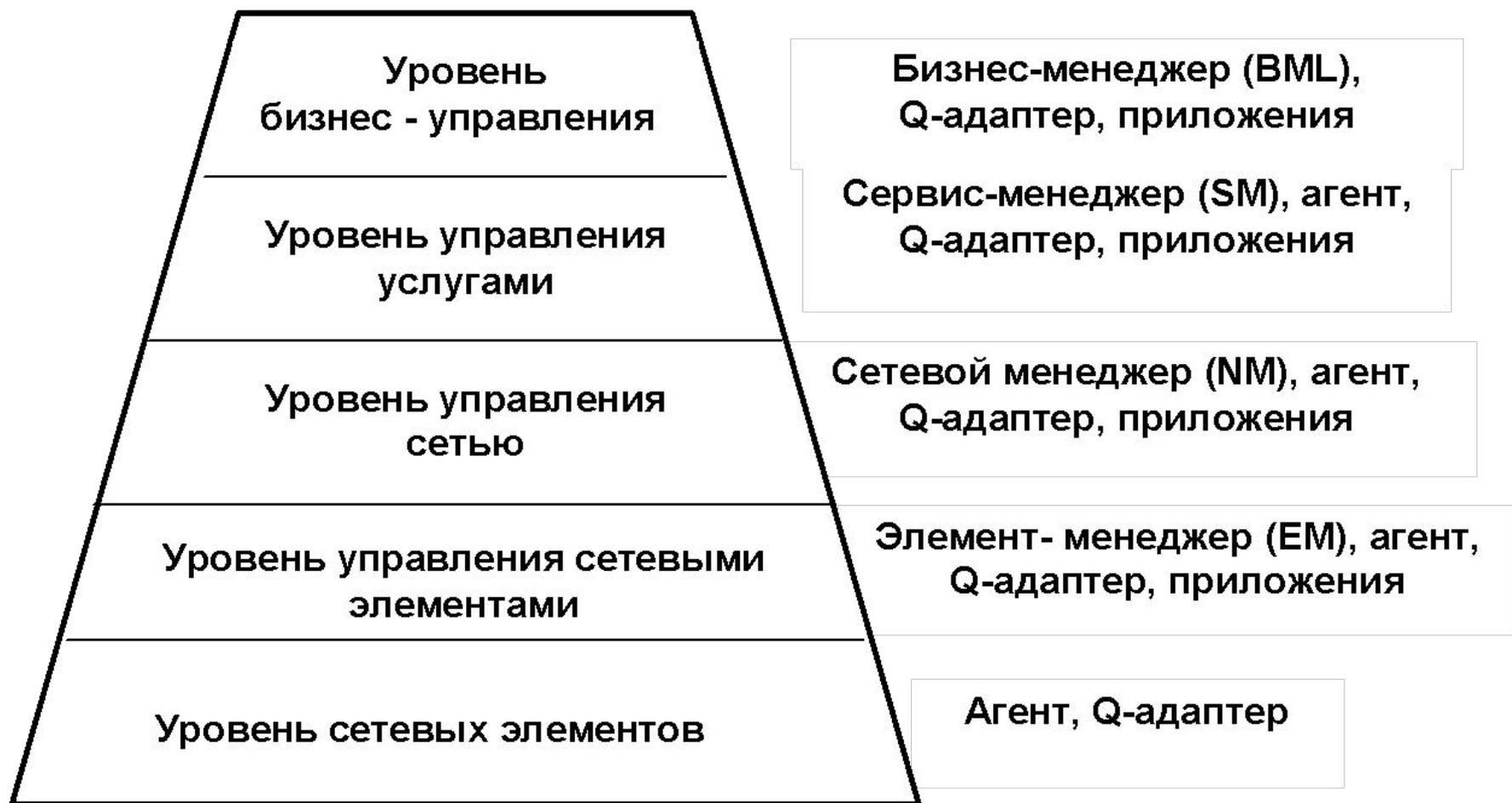
*Рис. 10.2. Логическая архитектура TMN*
