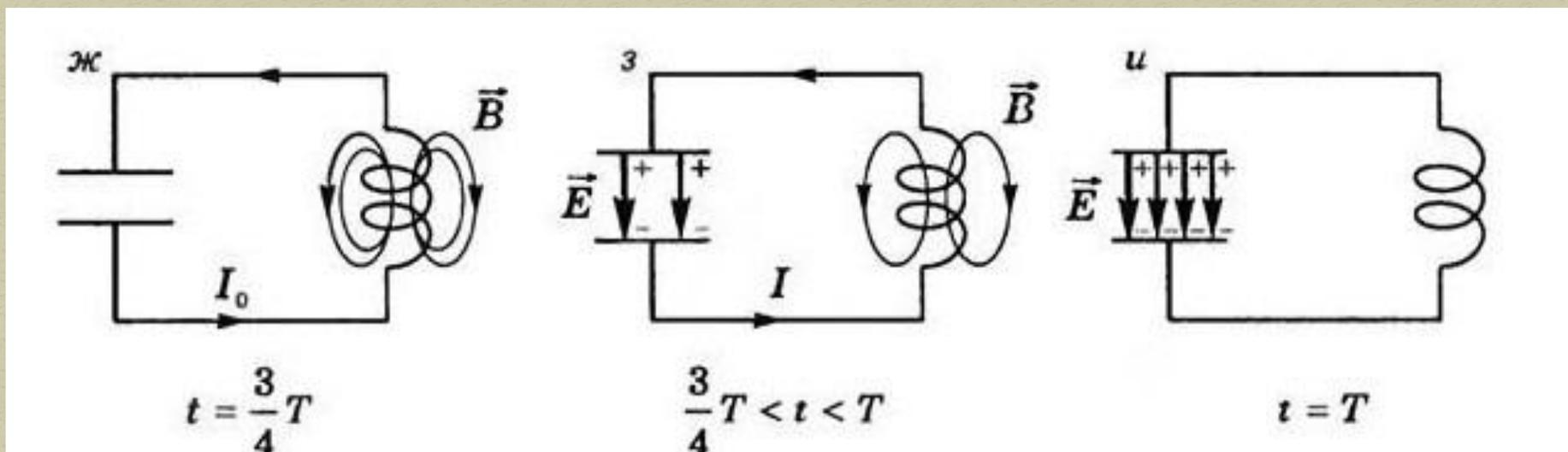
Происходят превращения энергии электрического поля конденсатора в энергию магнитного поля катушки с током , и наоборот.
