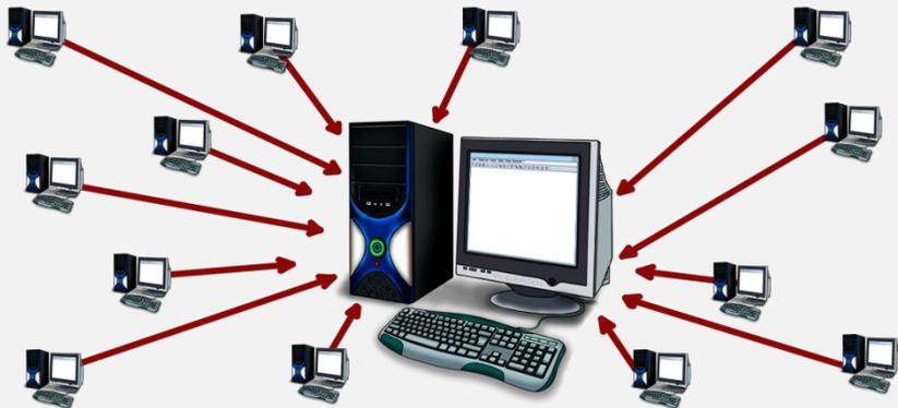
На жёстком диске сервера компьютеры, получившие доступ размещают файлы, а также периферийное оборудование и к оборудованию, размещенным на сервере, называются **клиенты**. компьютеров сети.
