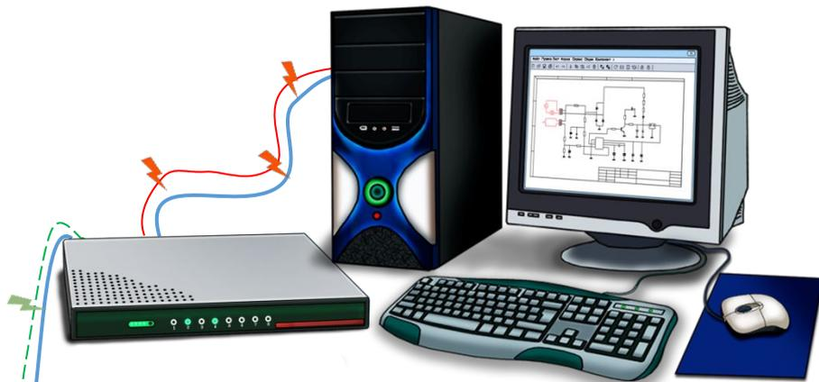
**Модем** – это специальное устройство, которое кодирует цифровой сигнал в аналоговый и передаёт по телефонной линии к другому, принимающему, устройству, которое сигнал декодирует.
