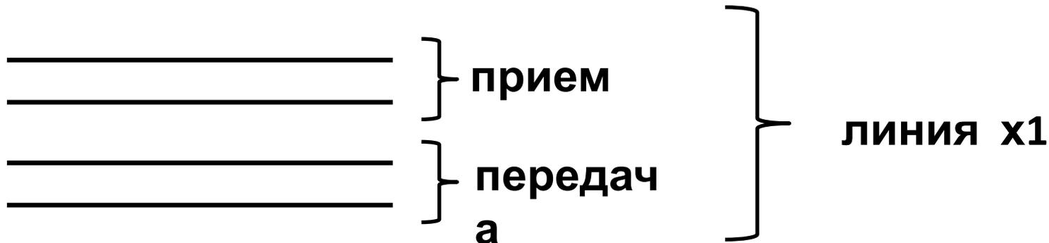
Соединение между двумя устройствами PCI Express может состоять из одной (x1) или нескольких (x2, x4, x8, x12, x16 и x32) линий x1 в зависимости от требуемой пропускной способности.
