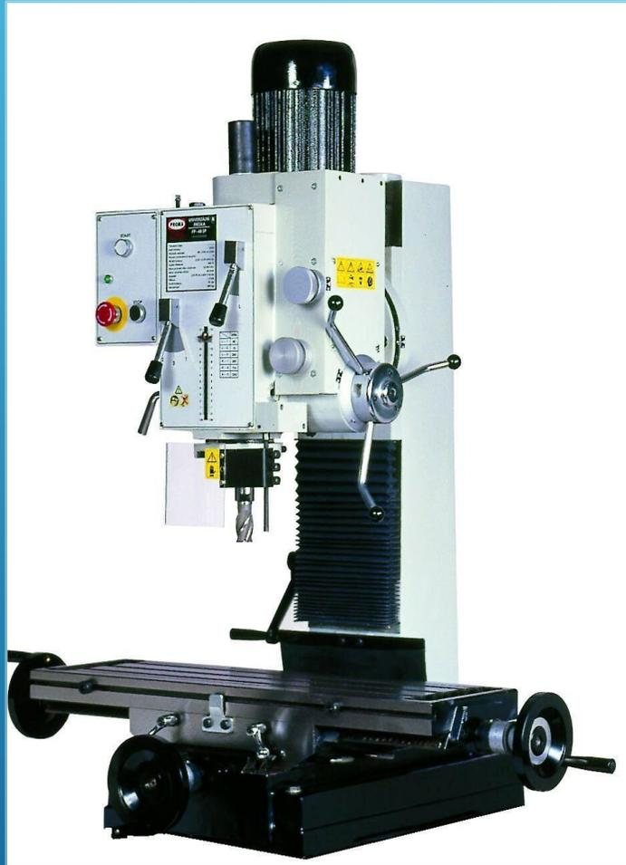
ФРЕЗЕРНЫЕ СТАНКИ ПРЕДНАЗНАЧЕНЫ ДЛЯ ОБРАБОТКИ С ПОМОЩЬЮ ФРЕЗЫ ПЛОСКИХ И ФАСОННЫХ ПОВЕРХНОСТЕЙ, ЗУБЧАТЫХ КОЛЁС И Т. П. МЕТАЛЛИЧЕСКИХ И ДРУГИХ ЗАГОТОВОК
