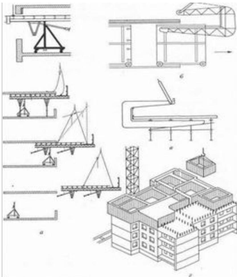
Рисунок 2. Порядок демонтажа элементов объемно-переставной опалубки.
