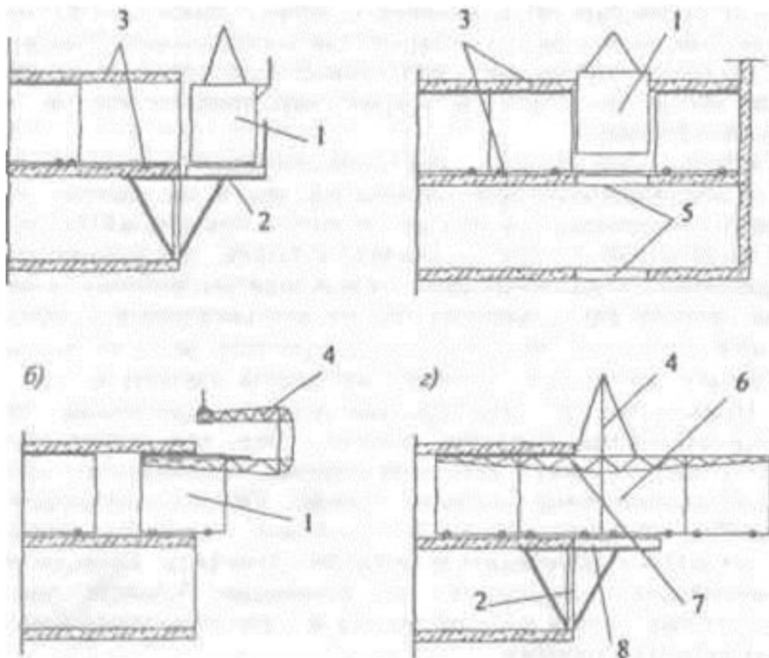
**Рисунок 5. Схема демонтажа объемно-переставной туннельной опалубки:**
