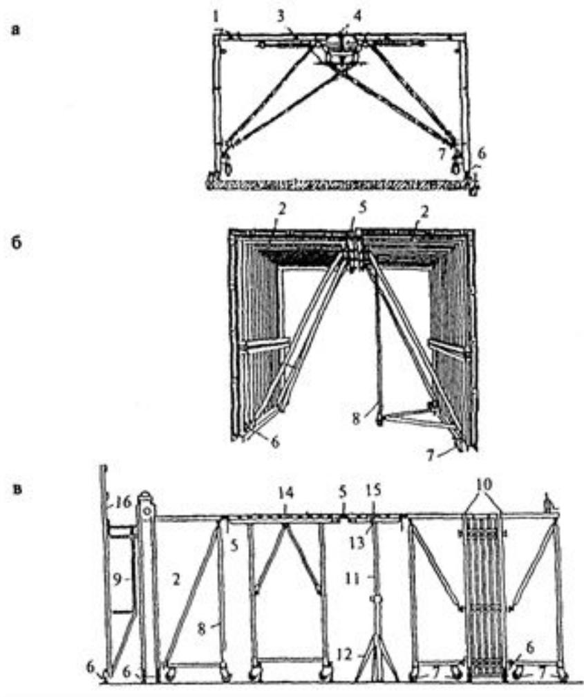
Рисунок 1. Объемно-переставная опалубка
