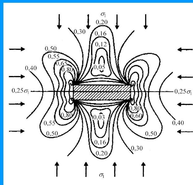
Изолинии напряжений вокруг прямоугольной выработки:
