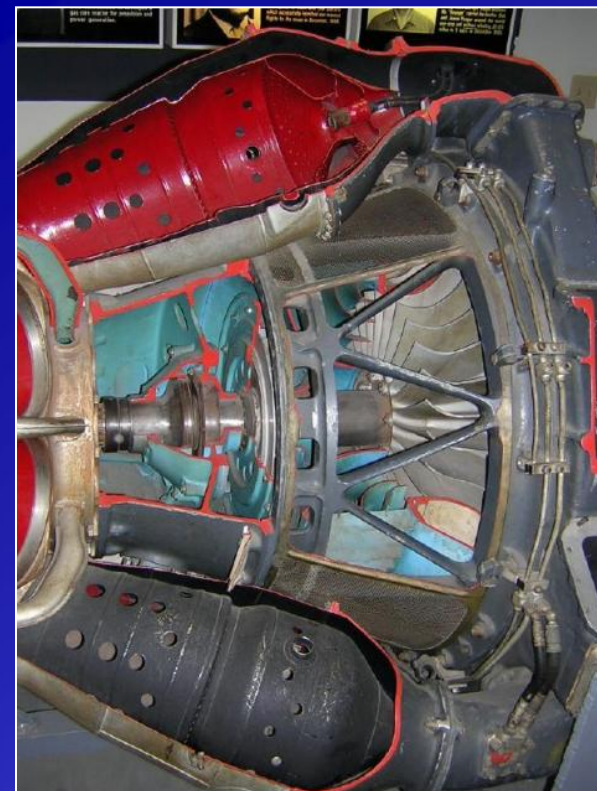
Трубчатые КС ГТД Rolls-Royce RB.41 Nene
