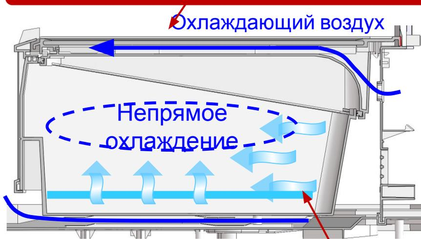
Контроль температуры благодаря пластине из нержавеющей стали
