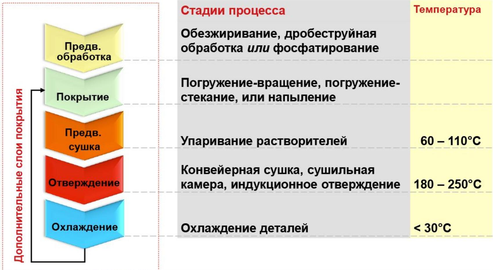
Последовательность процесса погружения-вращения (без предв. подготовки) можно повторять, чтобы добавить дополнительные слои покрытия, в зависимости от конкретных требований.
